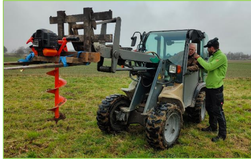
Spezialkonstruktion, da es schwerer Boden war.
